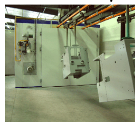
Bâtis en tôle et aluminium en sortie de four de cuisson
